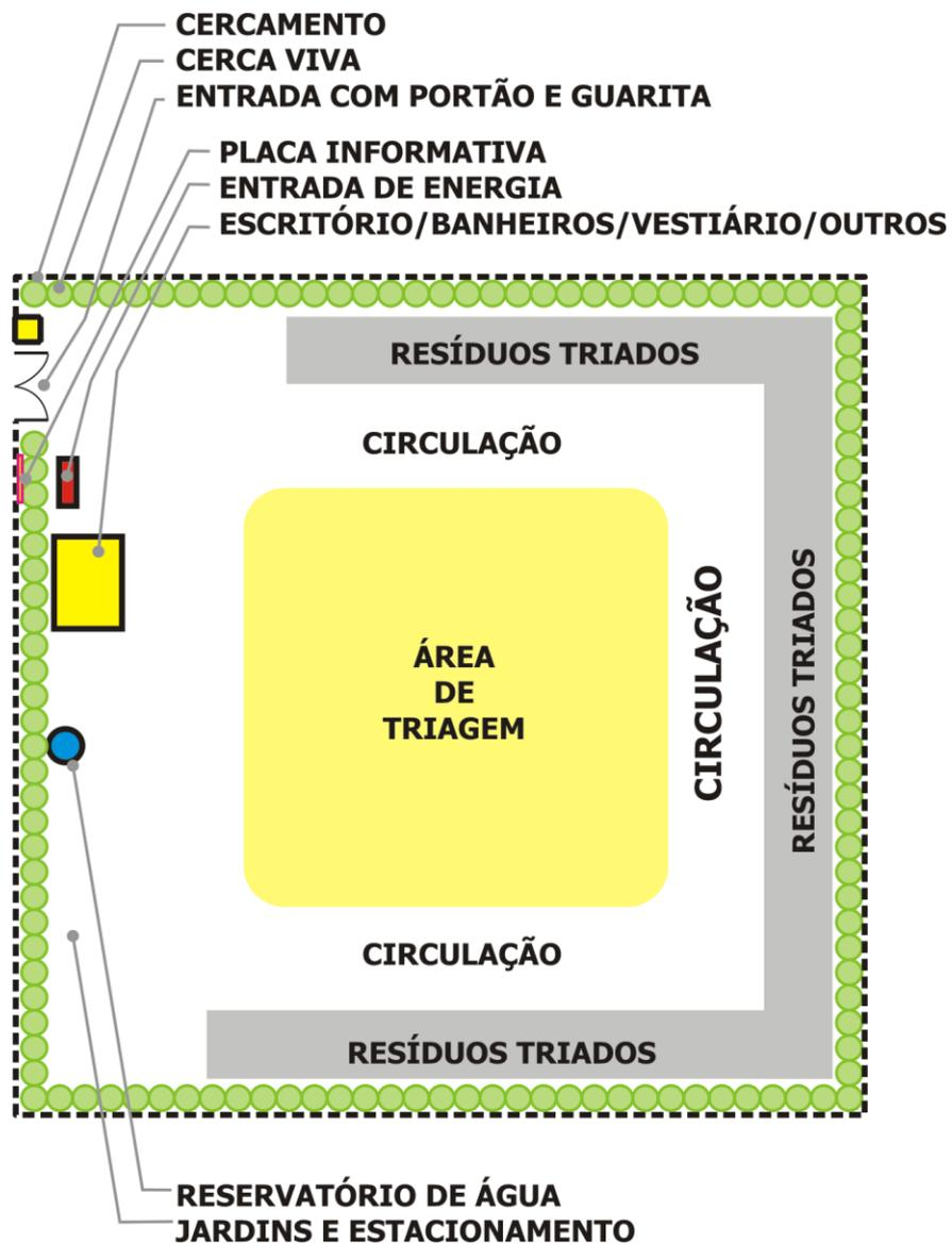
Representação esquemática de uma ATT
