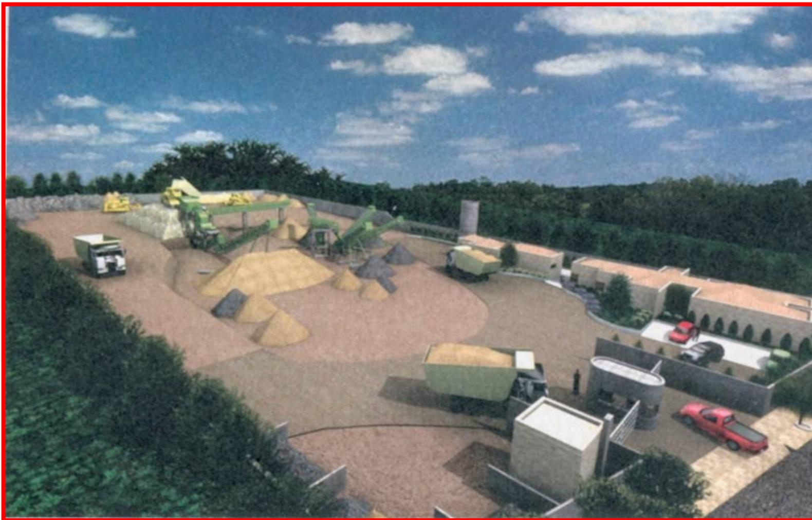
Representação esquemática de uma recicladora de resíduos de construção classe A
